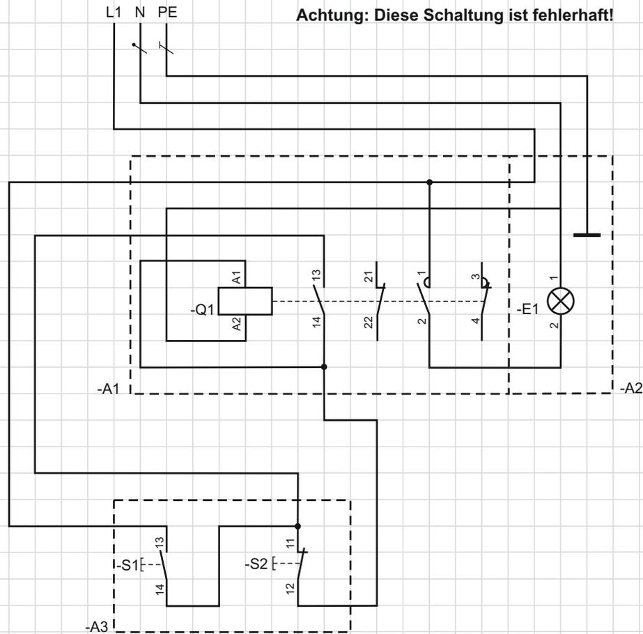
Stromlaufplan der fehlerhaften Schaltung
