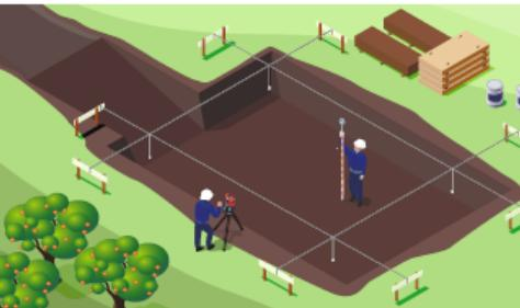
Abb. 54: Übertragung der genauen Tiefe der Grube
