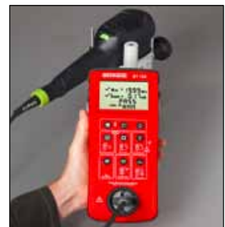
Abb. 1: Geräteprüfung an einem Elektrowerkzeug
