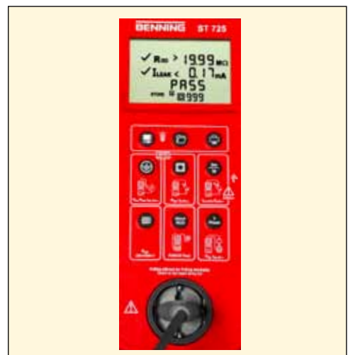
Abb. 2: Messgerät zur Geräteprüfung (Beispiel)
