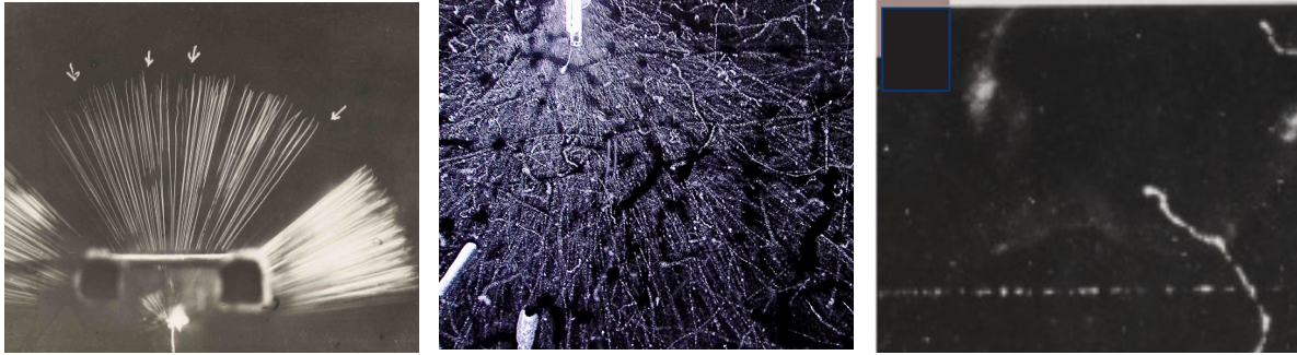
B2 a) Die Nebelkammeraufnahme von Irène Joliot-Curie zeigt die kurzen, dicken Spuren eines \alpha -Strahlers. b) \beta -Strahlen erzeugen in der Nebelkammer lange, dünne Spuren, die oft krummlinig sind. c) \gamma -Strahlung macht sich in der Nebelkammer nur durch herausgeschlagene Elektronen (Fotoelektronen) bemerkbar, die kurze stark gekrümmte Spuren hinterlassen.
