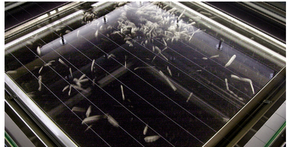
B3 In einer Nebelkammer machen helle Kondensstreifen radioaktive Strahlung „sichtbar“.
